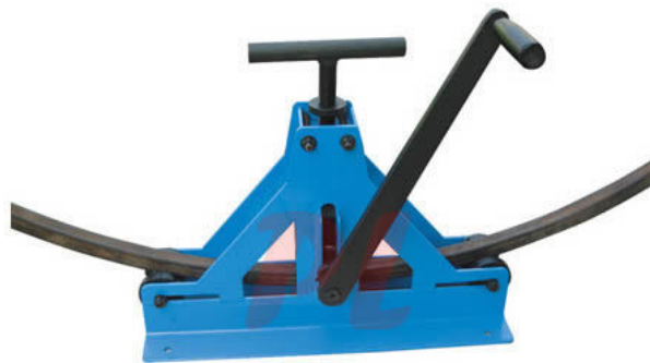
รูปตัวอย่างการดัดโลหะโครงสร้างบีซีซี
