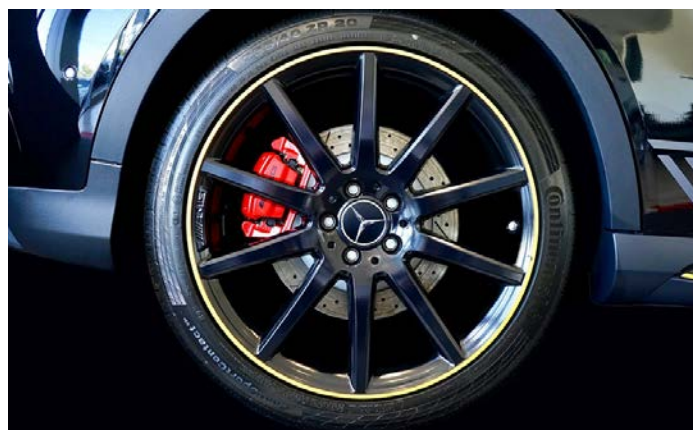
รูปล้อแม็ก ที่ทำมาจากแมกนีเซียมผสม
