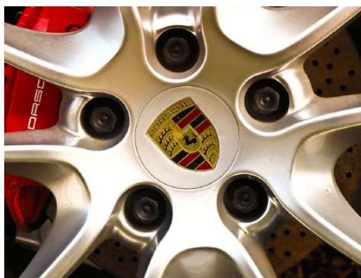
รูปกระทะล้อรถยนต์ที่เป็นแมกนีเซียมผสม
